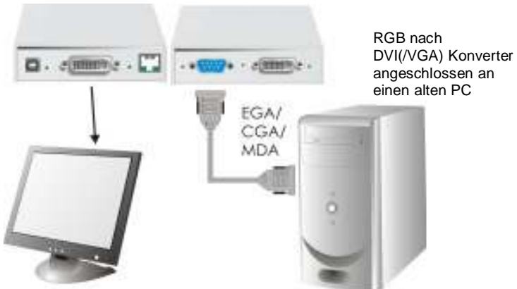
Bild 21 RGB nach DVI(VGA) Konverter mit optionalem EGA/CGA Adapter, angeschlossen an einen alten PC
